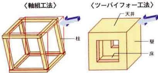
ツーバイフォー工法は、木造建築の工法で「木造枠組壁工法」のひとつです。なぜ「2」と「4」という数字が出てくるかというと、家を建てる時につかわれる角材のサイズが「2インチ×4インチ」であるためです。この均一サイズの角材と合板を接合して、柱や梁の代わりに壁、床、天井、屋根部分を構成し、それらを組み合わせて箱状の空間をつくっていきます。「2x4（ツーバイフォー）工法は、「軸組み工法」とは全く異なる考え方の建築工法で、大きな違いは、建物の支え方です。
