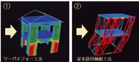
地震の揺れを六面体の建物全体で受け止めて力を分散・吸収し、重荷が一部分に集中する事を防ぐため、地震に対して抜群の強さを発揮します。
