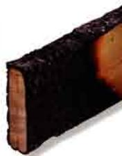
確かに木材は燃えやすい性質をもっています。しかし、ある程度の太さや厚さがある（つまり断面が大きい）木材は、いったん燃えても表面に炭化層をつくるだけ。火は内部まで進行しないため、強度が低下しにくいという性質をもっています。
